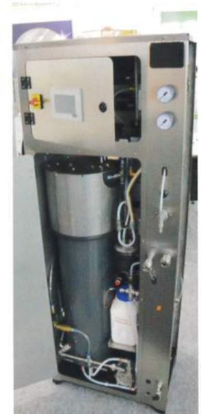
**Machine Pasteur HT 250** chez Martin Förster, pour de grands troupeaux où il y a besoin de pasteuriser le lait aux veaux.
