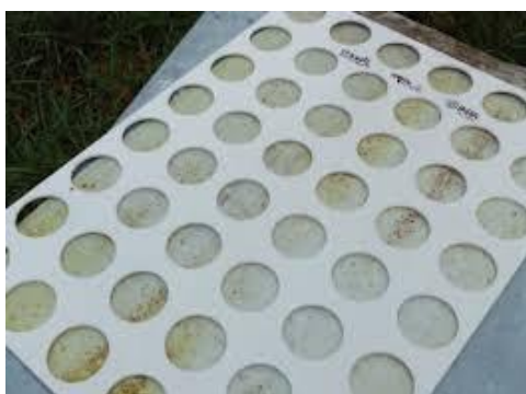
Figure 2 - Grille VarEval utilisée pour les comptages sur langes
